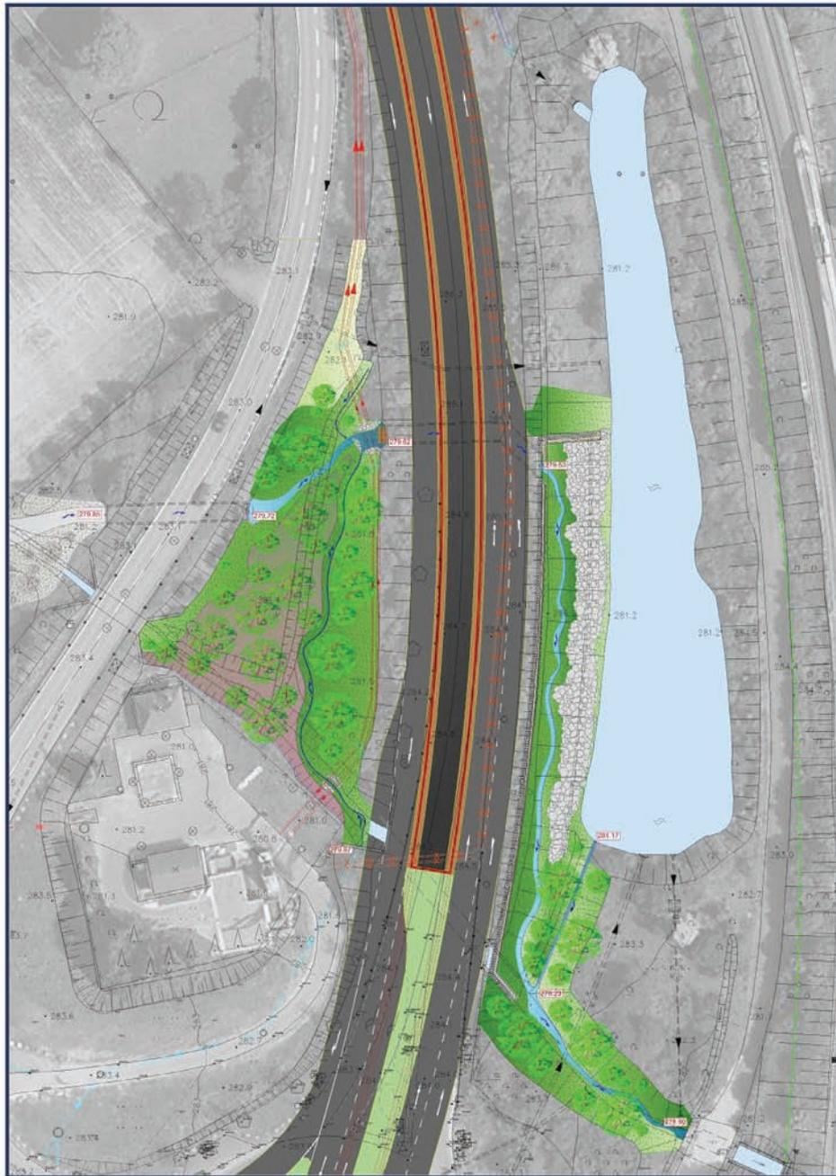
Le projet budgétaire finalement, prévoit ainsi le déplacement du ruisseau Drosbach, l'aménagement d'une zone humide entre la rue Gluck et la pénétrante de Bonnevoie ainsi que le déplacement des réseaux existants (conduite de refoulement pour eaux usées, conduite de refoulement pour les eaux de ruissellement en provenance de la pénétrante de Bonnevoie et du tunnel routier).
