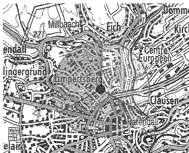
Bild 3 : Sektorielle Abdeckung einer Mobilfunkbasisstation mit 3 Antennen (ein Betreiber)
