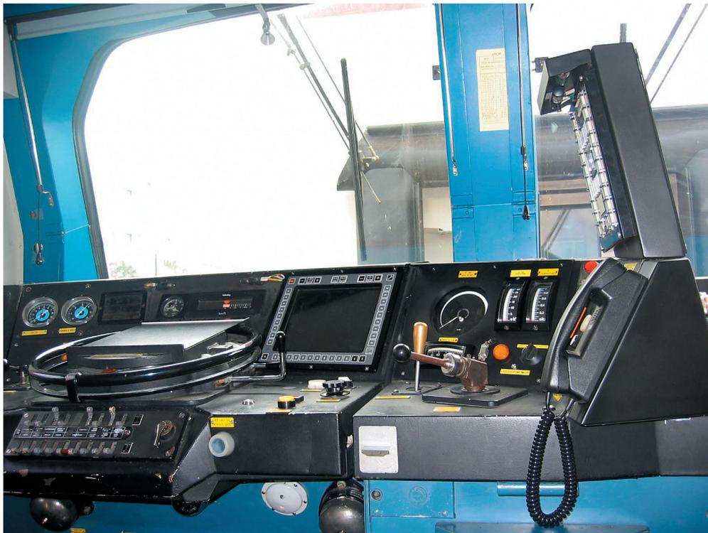
*DMI (Driver Machine Interface) monté en cabine durant les essais de validation.*
