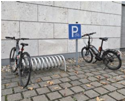
Vorderradhalter oder Felgenbrecher
