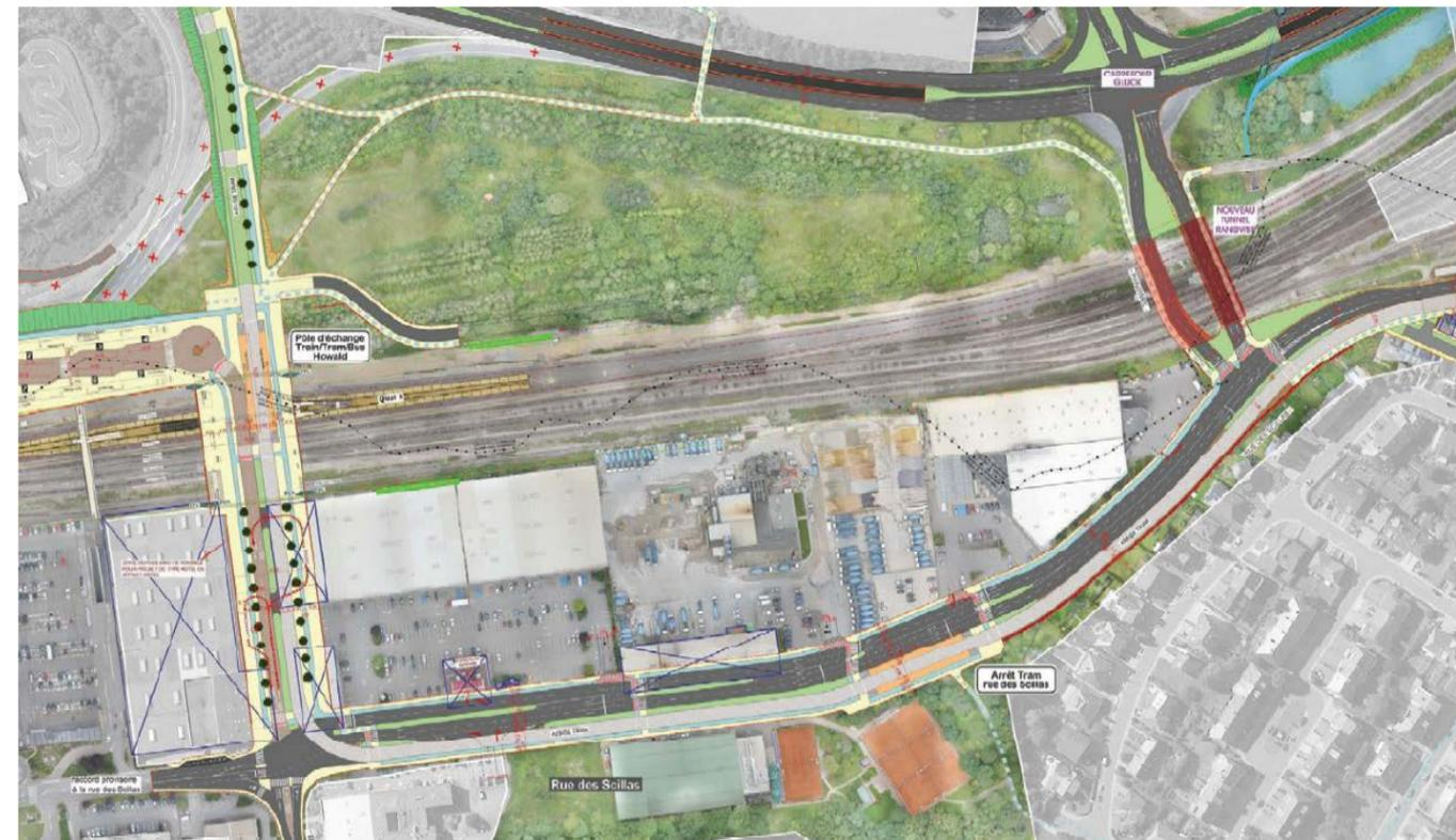
Le projet comprend la plateforme pour infrastructures de transports et de mobilité activé au dessus de la gare, le réaménagement de la rue des Scillas, le 2<sup>e</sup> tunnel Rangwee ainsi que le pont Y enjambant la A4/B4.
