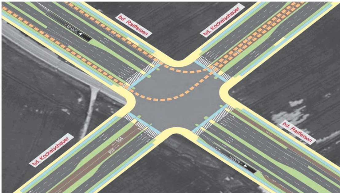
Figure 4: Détail 2, Boulevard Raiffeisen – Boulevard Kockelscheuer
