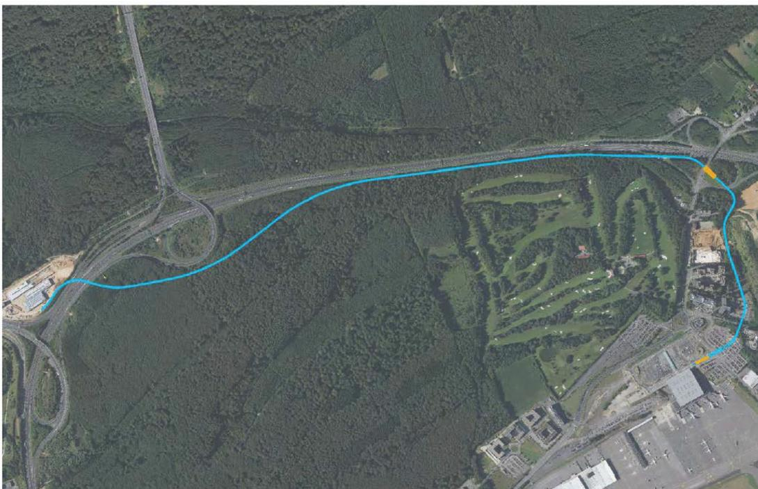
Le tracé prend son origine au Centre de remisage et de maintenance, traverse l'autoroute A1, longe l'autoroute dans le couloir fixé par le Plan d'Occupation des Sols « Aéroport et environs » avant de passer, par deux tranchées couvertes, sous la bretelle Ouest de l'échangeur de Senningerberg, puis sous la route nationale 1 et rejoindre le parking relais du Héienhaff. Le tracé emprunte ensuite le futur boulevard de Héienhaff et prend son terminus sur le parvis de l'aéroport du Findel.
