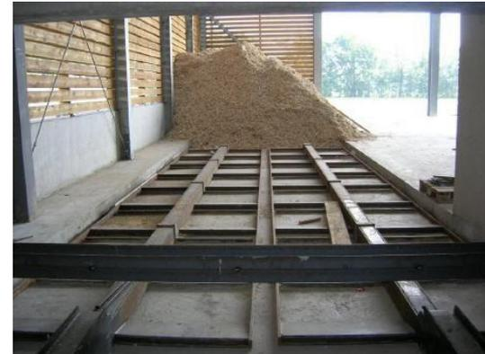
Schubboden, Quelle: E&I Energie und Innovation Ingenieurbüro
