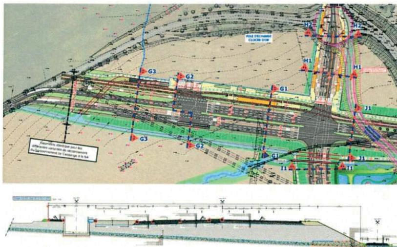
*Figure 42 Passage souterrain de 135m traversant le Boulevard Kockelscheuer avec la piste du Véloexpresswee à gauche*
