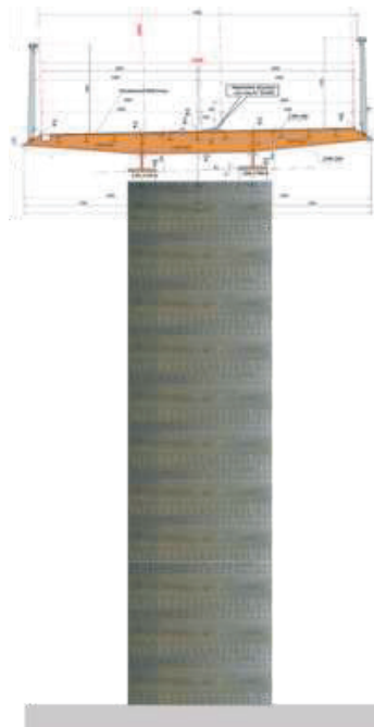
Figure 12 Pile béton du Lot 2 sur le tronçon longeant le site sidérurgique
