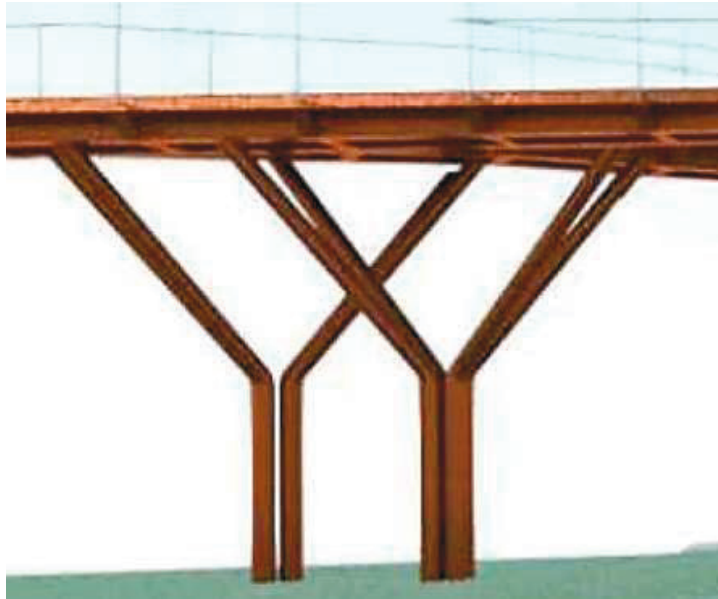
Figure 15 Pile métallique du Lot 2 à l'approche du site Belval
