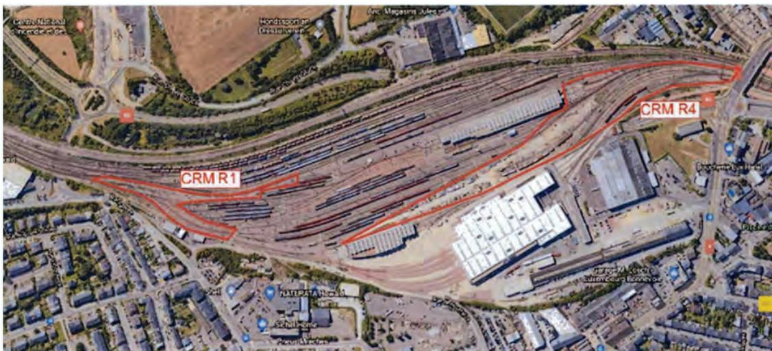
Ceci induit un réaménagement complet du plan des voies côté sud avec une modification des installations caténaies et une adaptation de la signalisation ferroviaire. Les quais métalliques existants seront prolongés et munis des équipements respectifs.
