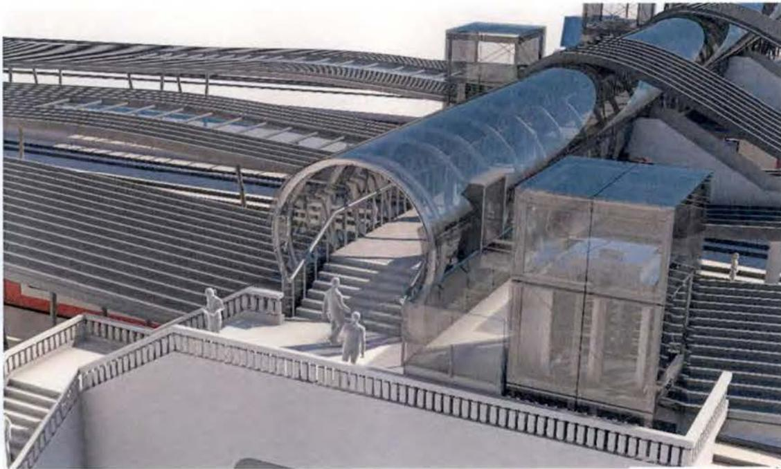
La largeur libre entre les mains courantes sera de 3,20 mètres et permettra le passage simultané de quatre personnes. La hauteur libre entre le revêtement et les équipements ou panneaux signalétiques sera de 2,40 mètres.
