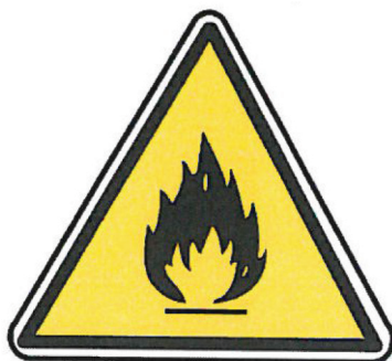
Matières inflammables ou haute température 1
