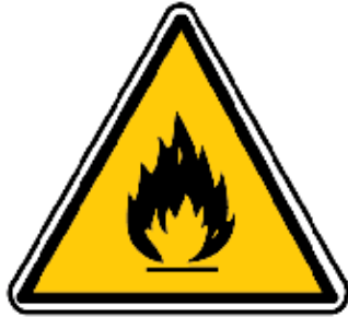
Matières inflammables ou haute température (*)
