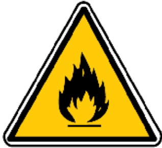
Matières inflammables ou haute température (*)
