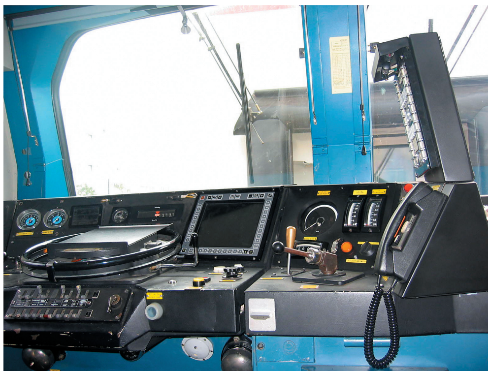
DMI (Driver Machine Interface) monté en cabine durant les essais de validation.
