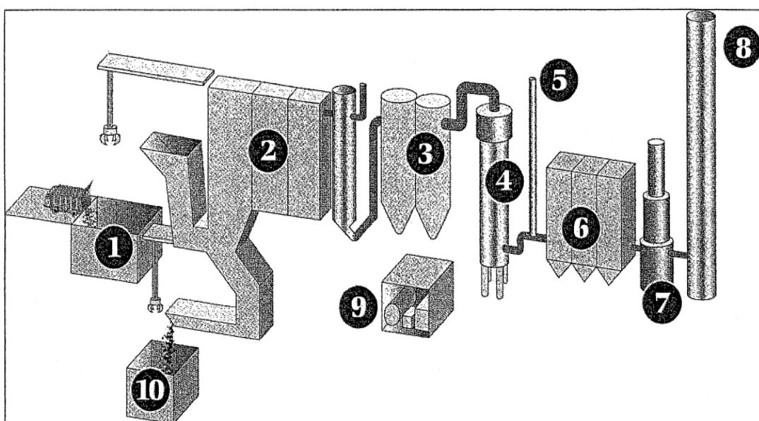
Après enregistrement des déchets à l'entrée du site de l'usine d'incinération, les véhicules déchargent dans la fosse (1) à déchets.
