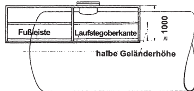
Arbeitsbühne mit freistehendem Geländer, z.B. bei Chemikalienfahrzeugen
