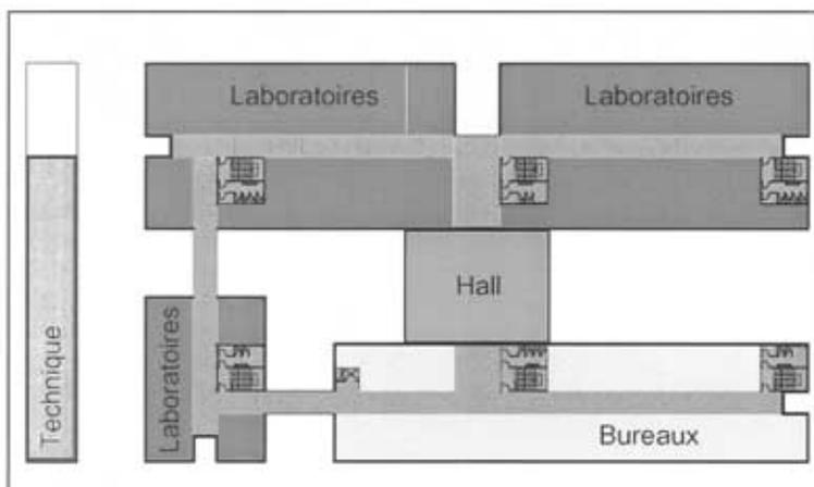
Le concept pavillonnaire du projet se base sur la notion d'ensembles fonctionnels regroupant les espaces aussi bien suivant leurs typologies techniques et opérationnelles que suivant leurs relations et interactions fonctionnelles. Ce concept ne doit cependant pas mener à un cloisonnement des équipes de chercheurs qui serait préjudiciable à la flexibilité d'utilisation des infrastructures et surtout à la qualité de l'environnement de travail.
